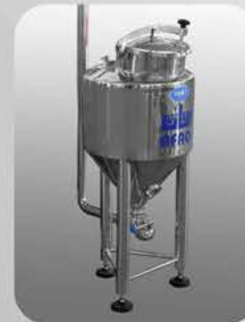
خزان مساحيق مع نظام تخلية Powder tank with vacuum system using vacuum
