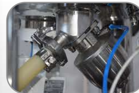
صمامات تفريغ آلية مخصصة للسوائل العقيمة Automatic Discharge valve
