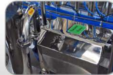
مضخة تخلية لسحب المساحيق للخللاط. pump to charge powder into preparation tank
