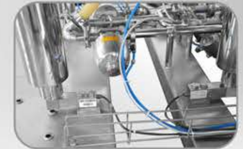
نظام وزن مستمر للمواد بواسطة خلايا وزن. Continuous capacity control of materials by load cells
