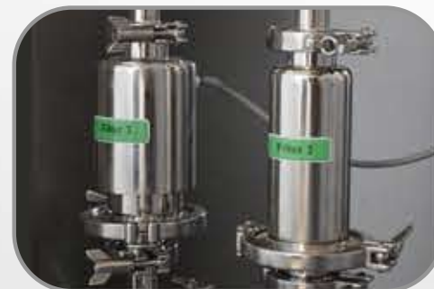
فتحة تزويد نيتروجين مع مرشح جرثومي لسحب الأوكسجين المنحل ضمن المحلول Nitrogen inlet for purging with microbial filter
