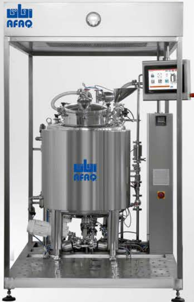
عزل كامل لحيز التحضير بواسطة نظام LAF أو عازل مع RABs Preparation area isolated by LAF or isolator with RABs
